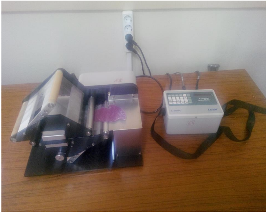
Şekil 3.3. Li-Cor, LI-3000C marka yüzey alanı ölçen cihazla MLD alanının ölçülmesi
