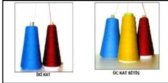
Resim 33 : Triko Makinesinde Kullanılan 2 Kat ve 3 Kat Kullanılan Koniye Sarılı İplikler. Kaynak : Ferrezza, Hefferen, 2008, s.147.
