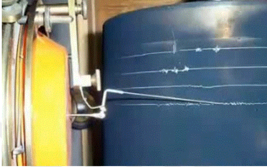
Resim 4 Koni üzerindeki ses dalgalarını titreşerek isli kağıt üzerine işleyen iğne mekanizması.
