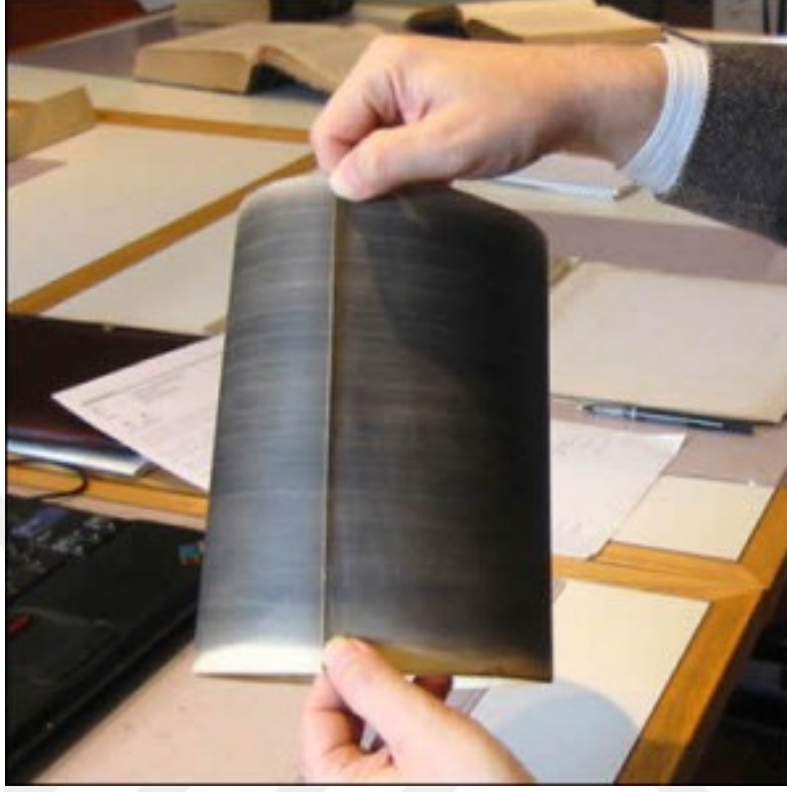
Resim 2. İlk ses kayıt makinesinde kullanılan, gaz lambası isi ile islenmiş kağıt.
