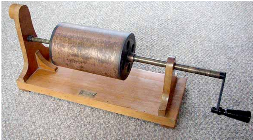
Resim 3. İslî kağıdın sarıldığı merdane mekaniği.
