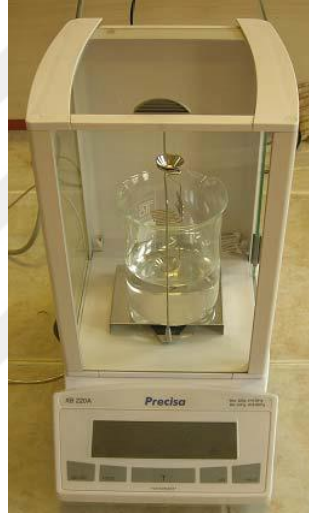
Şekil 3.7. Yoğunluk ölçümlerinde kullanılan Precisa™ XB220A tartım cihazı
