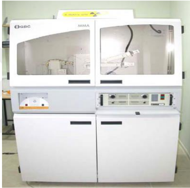
Şekil 3.6. X-ışını difraksiyon çalışmalarında kullanılan GBC MMA 027 model XRD cihazı
