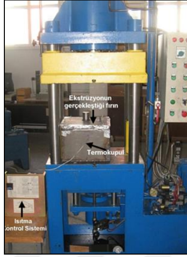
Şekil 3.5. Sıcak ekstrüzyon işlemi için tasarlanan fırın kontrol ünitesi ve 100 ton kapasiteli dikey eksenli pres
