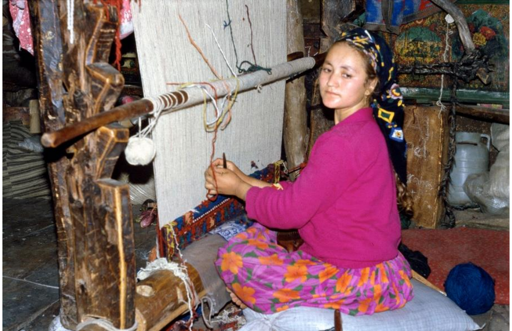
Resim 122: Çözü sarmalı ahşap tezgâh. Foto: Ş. Atlhan
