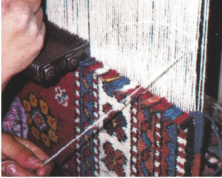
Resim 151: Zemin atkısının kirkit ile yerleştirilmesi 83 .
