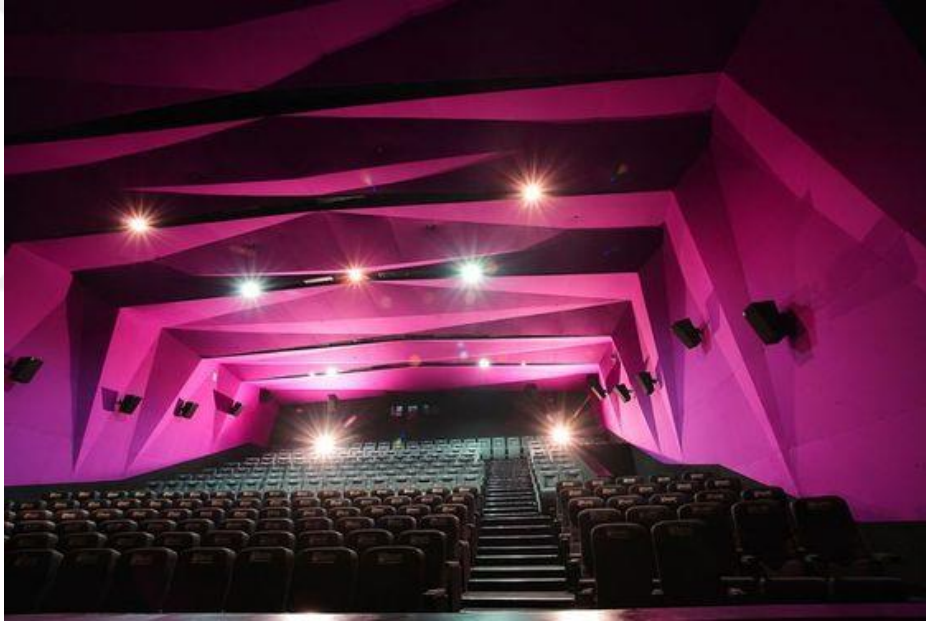
Resim 3. Duvar ve Tavan Formu ile Ses Kontrolü
