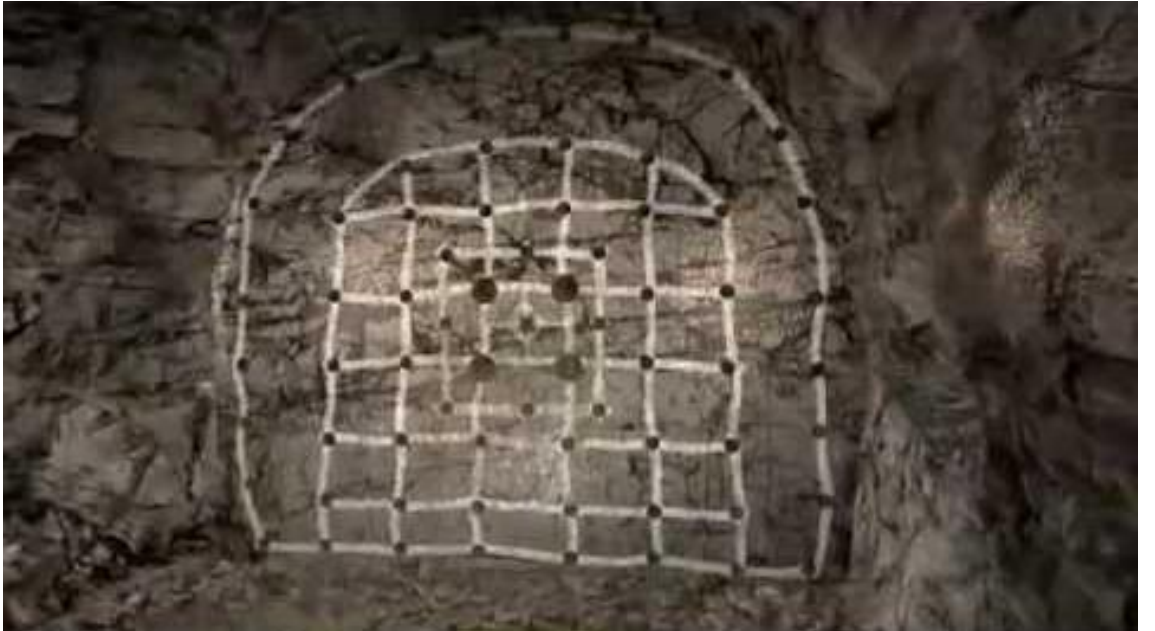
Şekil 1.4. Paralel delik yöntemi ayna tasarımı (www.delmeplatlatma.org)
