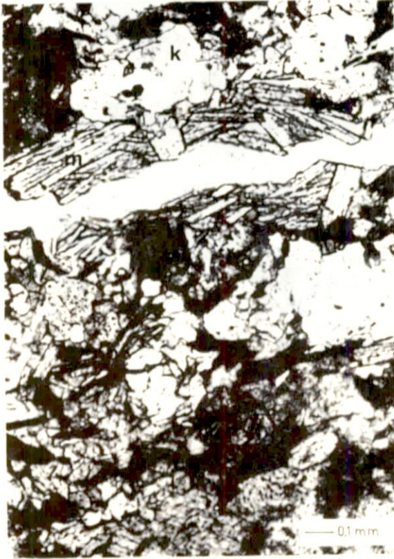
Foto- 2 Muskovit-Biyotit gnays: Biyotit (b), muskovit (m) kuvars (k), ortoklas (o) seviyelerini genç bir kuvars damarı kesmektedir. Çapraz nikol X 56
