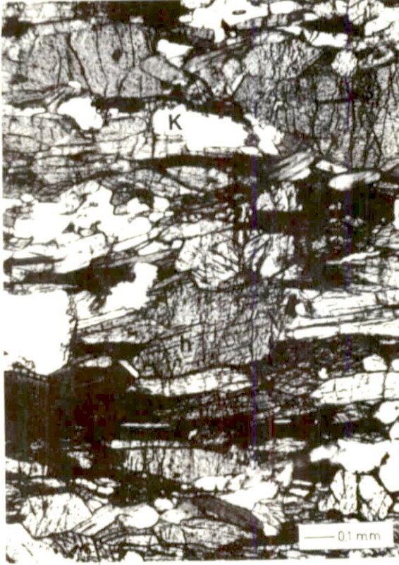
Foto- 7 Amfibolit. Hornblend (h), biyotit (b), kuvars (k). Çapraz nikol X 56
