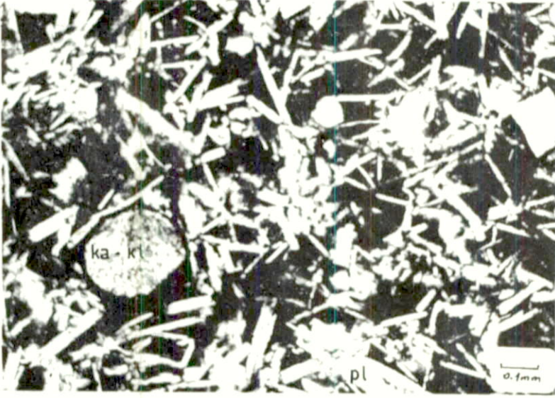
Şekil 101 Spilitleşmiş diyabazlarda ofitik doku, albitleşmiş plajiyoklaz (pl), boşluklarda gelişmiş kalsit ve klorit (ka-kl) minerallerinin ince kesitte görünümü (XN). Mutu'nun 1 km kuzeyi.
