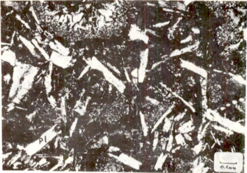
Şekil 100 Ofiyolitli tektonik karmaşık serideki metadiyabazların kalıntı ofitik dokuları, albitleşmiş plajiyoklazlar (pl) ve boşluklarda gelişmiş klorit (kl) mineralleri (XN). Güzikendüzü mezrasının 500 m batısı.
