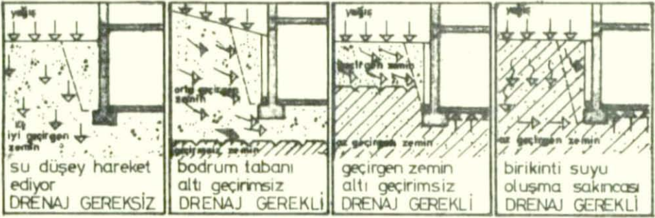
Şekil 11. Yapıda drenaj gerektiren durumlar.
