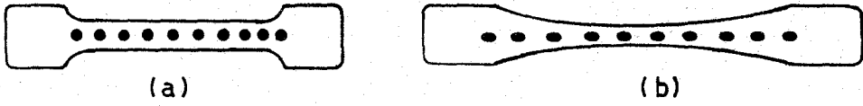
Şekil-4.3: Letraset ile işaretlenmiş örnek maddenin a) çekilmeden önceki, b) çekilmeden sonraki sematik görünüşleri
