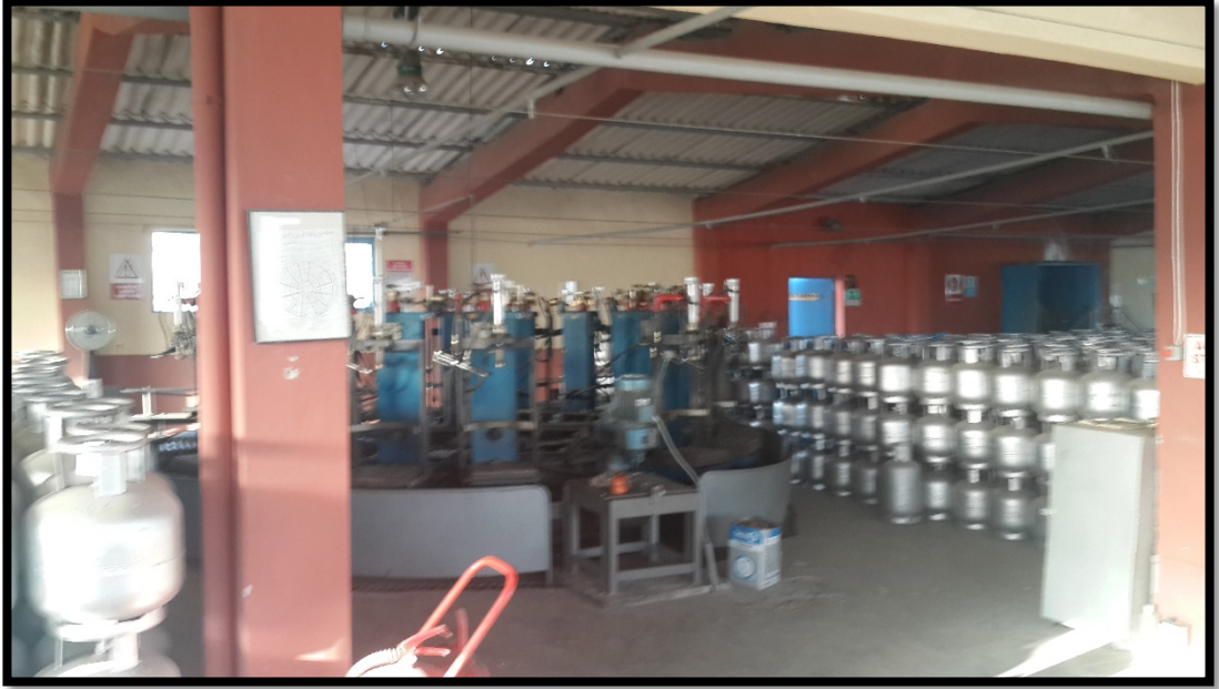
Şekil 3.4. 12 kg kapasiteli tüpler için LPG dolum karruseli
