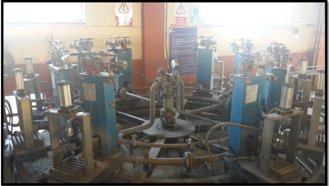
Şekil 3.6. 2 kg kapasiteli tüpler için LPG dolum karruseli
