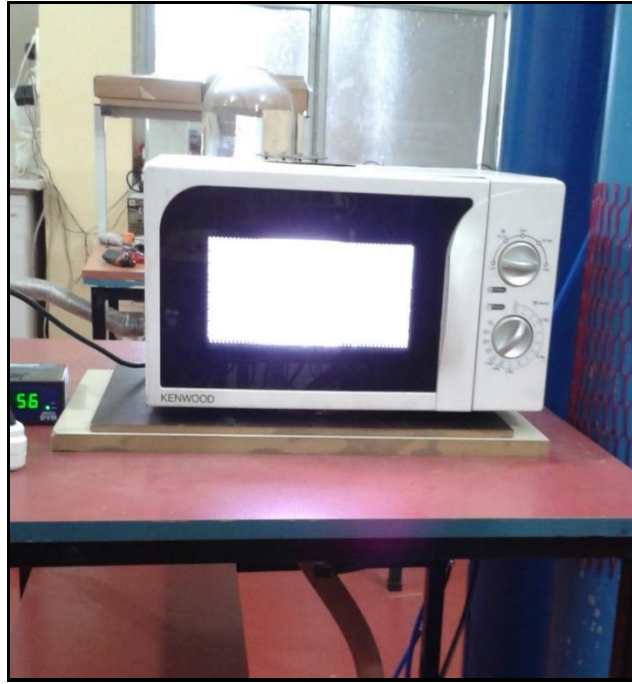
Şekil 3.1. Mikrodalga plazma cihazında plazma oluşurken çekilen bir görüntü.
