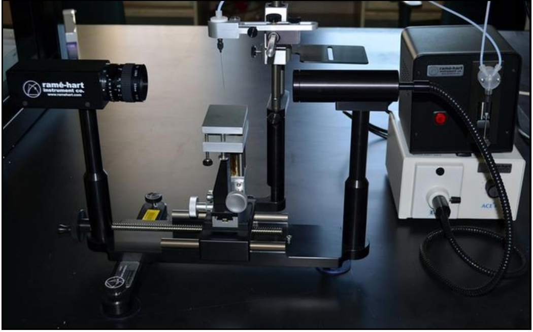
Şekil 3.7. Temas açısının ölçüldüğü temas aç ölçer (goniyometri cihazı)
