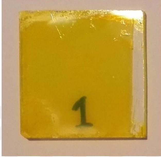
Şekil 4.12. 1:1 oranında hazırlanan EDDPbI 4 filmi
