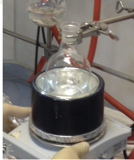
Şekil 3.3. Çeker ocak içinde, MAI tuzu hazırlama düzeneği
