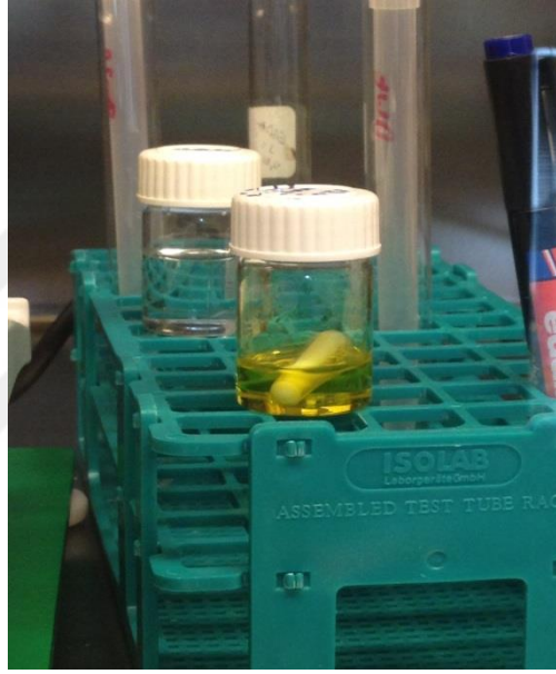
Şekil 3.4. PbI_2 ve MAI karışımından elde edilen perovskit çözeltisi
