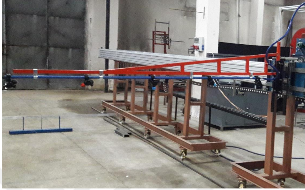
Şekil 3.6. Püskürtme simülatörünün bum kolu
