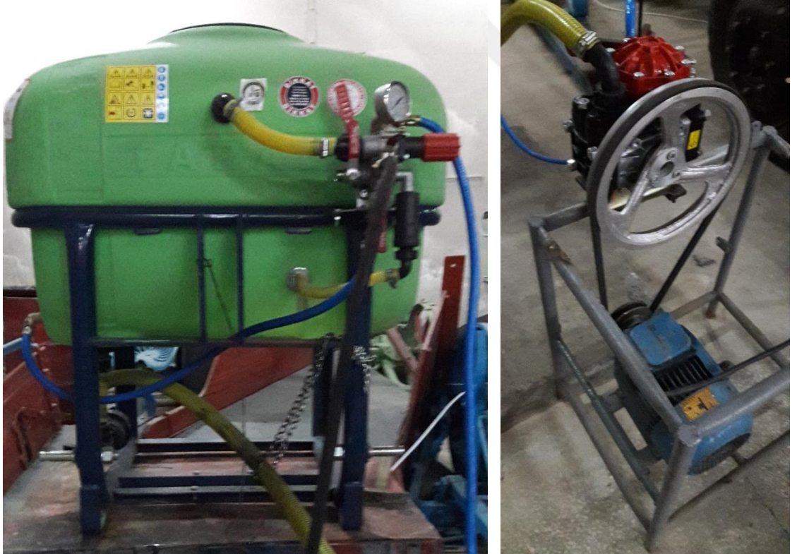
Şekil 3.3. Paternatörde hidrolik basınç ve enerji kaynağı
