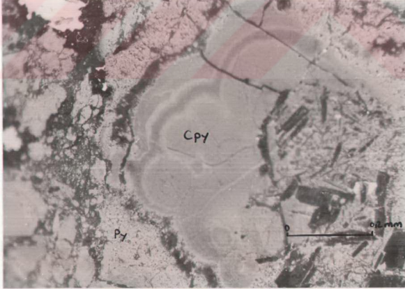
Şekil 5.14 Bazı kesitlerde izlenen jel yapılı kalkopirit ve pirit beraberliği (T.N.). (Py=Pirit, Cpy=Kalkopirit)
