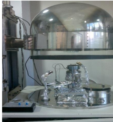
Şekil 3.1. Nano-Teknoloji Laboratuvarı saçtırma sistemi.
