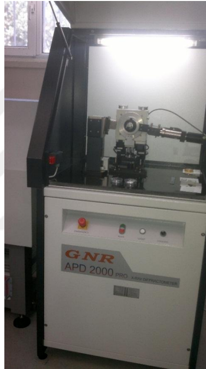
Şekil 3.16. Nano-Teknoloji Laboratuvarı X-Işını Kırılma (XRD) sistemi
