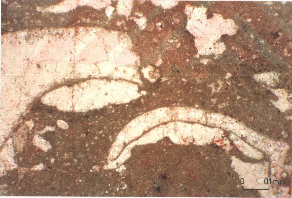
Şekil 5.26. Gastropod kavkısının alt kısmında gelişmiş olan pendant çimentonun mikroskopik görünümü. (intra-klastlı grainstone-Wackestone litofasiyesi, örnek no: 262; Suiçti kesiti).
