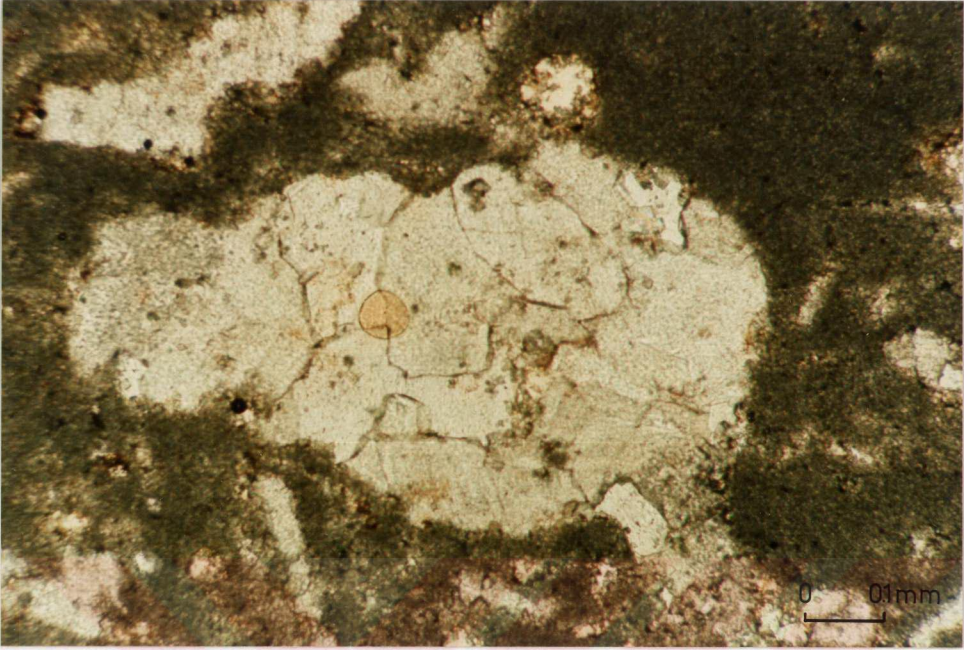
Şekil 5.11. Idiopathic-C tip dolomitleşmenin mikroskopik görünümü (dolomi litofasiyesi, örnek no: 114; Keçi Deresi kesiti).
