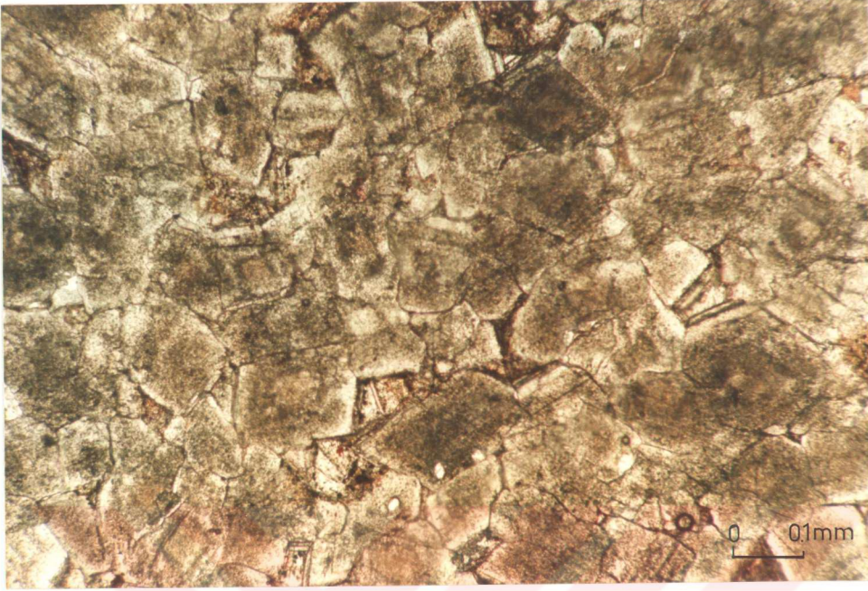
Şekil 5.10. İdiotopic-S tip dolomitleşmenin mikroskopik görünümü (neomorfik kireçtaşı litofasiyesi, örnek no: 22; Suiçti kesiti).
