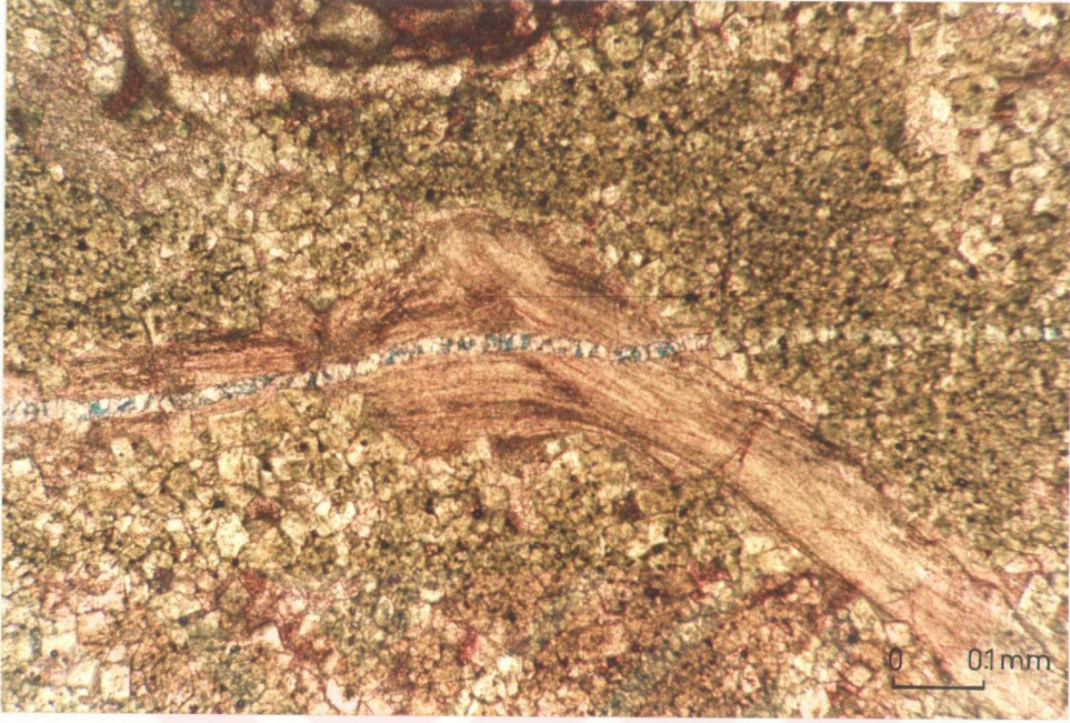
Şekil 5.16. Geç diyajenetik süreçte oluşmuş dolomitleşme. Kayacın dolomitleşmemiş kısımlarındaki (pelecypod kavkısının içinden geçen) ikincil çatlakların equant spari kalsitle dolu olmasına karşın, kayacın dolomitleşmiş kısımlarındaki aynı çatlakları dolduran equant spari kalsitin dolomitte yer değiştirdiğine dikkat ediniz (dolomi ve dolomitli grainstone-packstone litofasiyesi, örnek no:152; Keçi Deresi kesiti).
