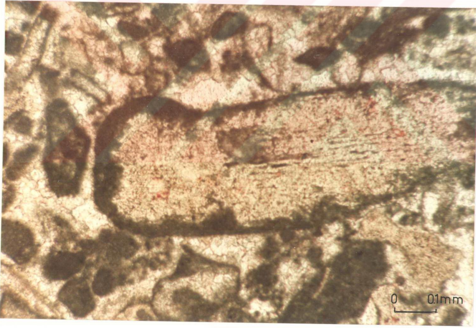
Şekil 5.3. İskelet taneleri üzerinde gelişmiş olan mikritik zarflanmanın mikroskopik görünümü. Mikritik zarflanmanın tüm taneyi kaplayacak şekilde geliştiği ve zarflanma ile altere olmamış kısım arasındaki sınırın girintili çıkıntılı olduğuna dikkat ediniz (Intraklastlı grainstone-wackestone lito-fasiyesi, örnek no: 290; Suiçti kesiti).
