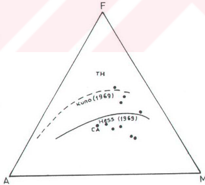
Şekil 4.3 AFM diyagramında (Kuno, 95; Hess, 96) Pontid Alt Bazik Karmaşığı'na ait bazaltların konumu. (A = \text{Na}_2\text{O} + \text{K}_2\text{O} , F = \text{FeO}^* , M = \text{MgO} )
