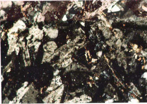
Şekil 2.7 Diyabazların mikroskopik görünümü. Pl: Plajiyoklas, Kl: Klorit (Ç.N.).
