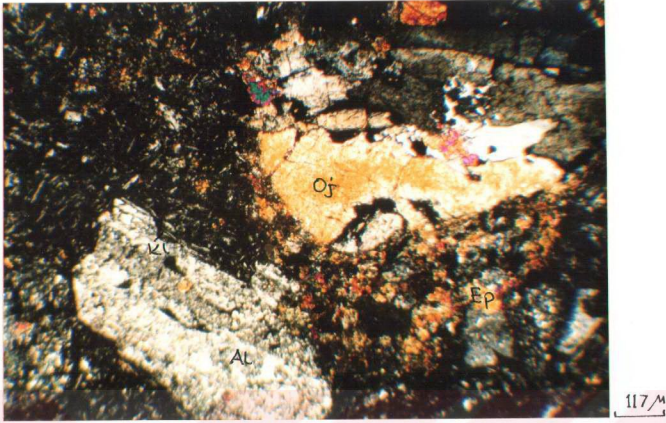
Şekil 2.8 Pontid Alt Bazik Karmaşığı'na ait spilitleşmiş bazaltların mikroskobik görünümü. Al: Albit, Ep: Epidot, Kl: Klorit, Oj: Ojit
