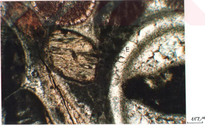
Şekil 2.11 Berdiga Formasyonu içindeki dolosparitlerin mikroskobik görünümü. E: Echinid plakası, V: Volkanik kayaç parçası (Ç.N.)
