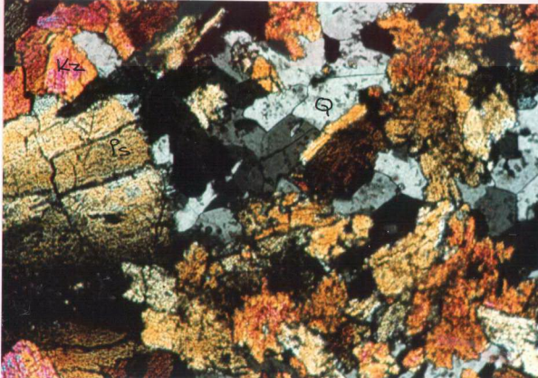
Şekil 2.37 Boynuztaşının mikroskobik görünümü. Ps: Pistaşit, Kl: Klinozoisit, K: Kuvars. (Ç.N.)
