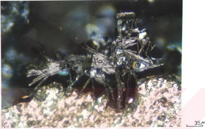
Şekil 5.18 Potassik zonda cevher mineralleri. Mo: Molibdenit, Py: Pirit, Q: Ku- vars.
