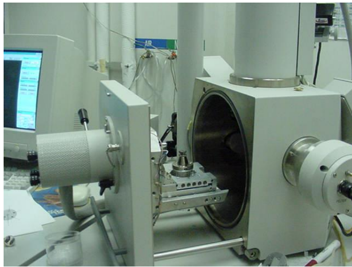
Şekil 3.2. Taramalı elektron mikroskobunun vakum odasının görüntüsü
