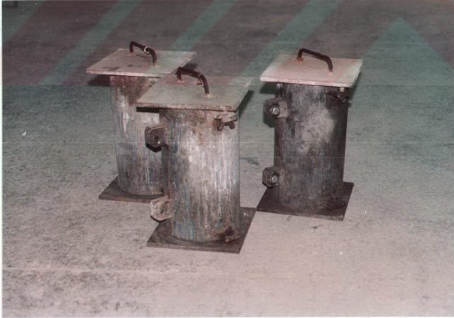
Fotoğraf 3.9. Beton Yerleştirilip Kapakları Kapatılan Silindirik Numune Kalıpları
