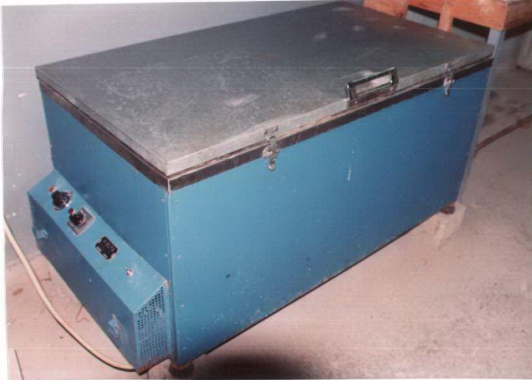
Fotoğraf 3.6. Değiştirilmiş Sıcak Su Yönteminin Uygulandığı ALFA Marka Hızlandırılmış Kür Tankı
