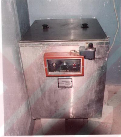
Fotoğraf 3.5. Sıcak Su Yönteminin Uygulandığı SOILTEST Marka Hızlandırılmış Kür Tankı
