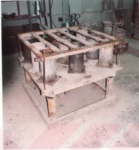
Fotoğraf 3.8. Vibratör Üzerine Yerleştirilen Kalıplar ve Izgara
