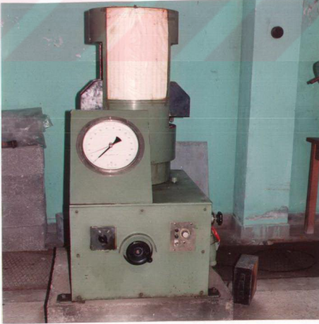
Fotoğraf 3.4. 300 kN 'lik Hidrolik Pres
