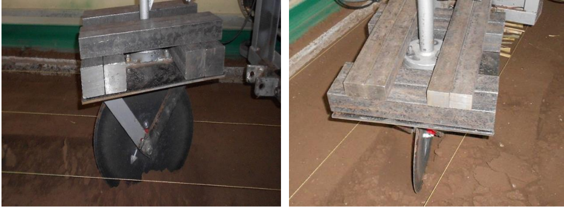
Şekil 3.14. Gömücü ayak ünitesi üzerine konularak kullanılan dişey ağırlıklar
