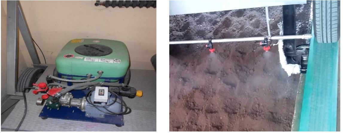
Şekil 3.3. Toprağın nemlendirilmesi için kullanılan pülverizatör ve su püskürtme işlemi
