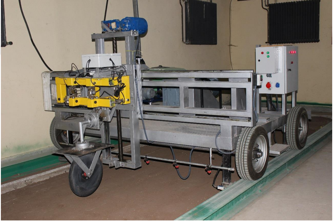
Şekil 3.1. Toprak kanalı ve kanal arabası
