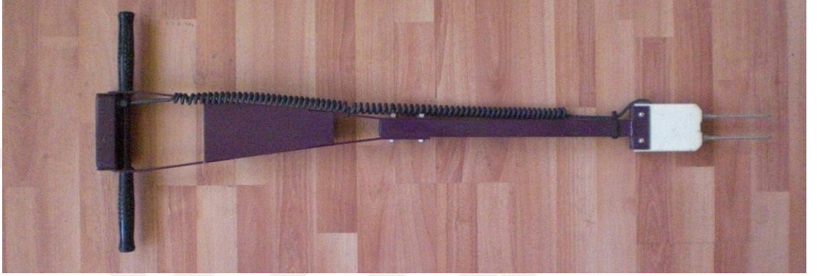
Şekil 3.7. TDR 300 toprak nemi ölçme cihazı
