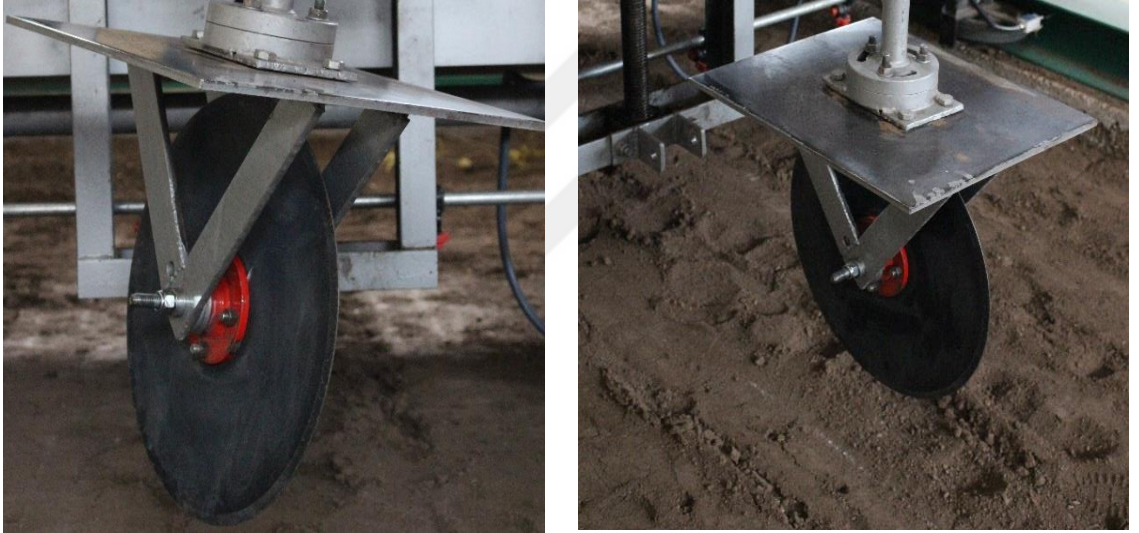
Şekil 3.2. Tek diskli tip gömücü ayak ünitesi
