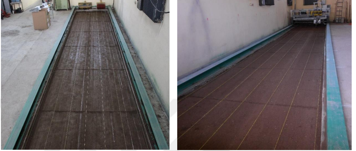
Şekil 3.8. Toprak kanalının parsellere ayrılması
