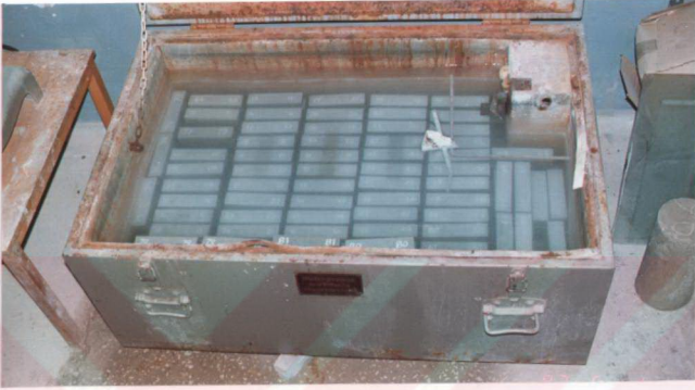
Şekil 19. Kür tankındaki numuneler
