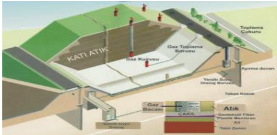
Şekil 2.2. Katı atık depolama sahası şeması (Anonim 1991)
