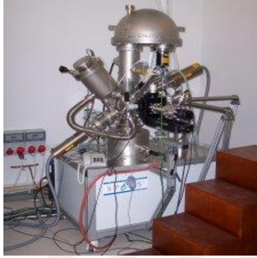
Şekil 3.8. XPS cihazı (McMullan 2006)
