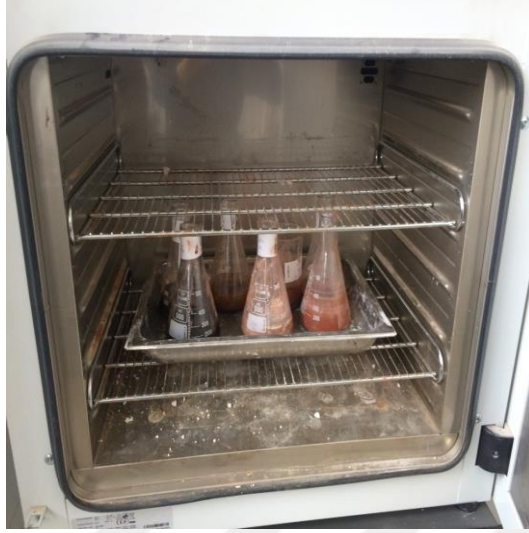
Şekil 3.5. Üretiken katkıli killer etüvde kurutulurken
