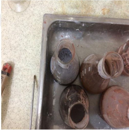
Şekil 3.6. Katkıli killer kurutulduktan sonra
