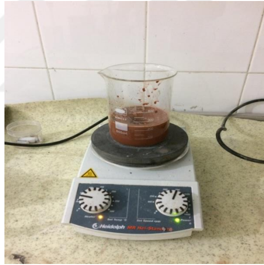
Şekil 3.4. Magnetik karıştırıcıda katkılı kil üretimi
