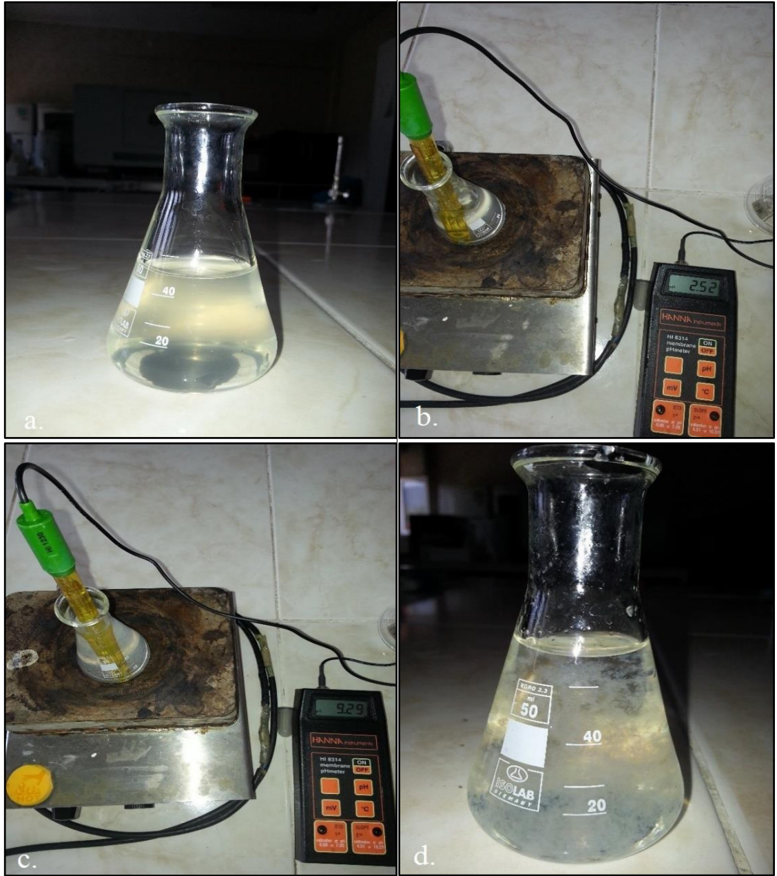
Şekil 3.4. Kitosanın çöktürülmesi işlemi
