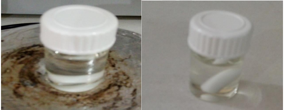
Şekil 3.16. Etil selüloz ve alpha terpineolden yapılmış macun karışımı
