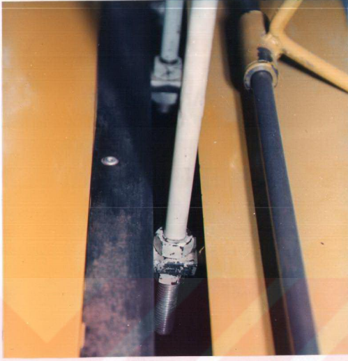
Resim 3. Çemberlerin yüksekliklerinin verildiği çift somun sistemi
