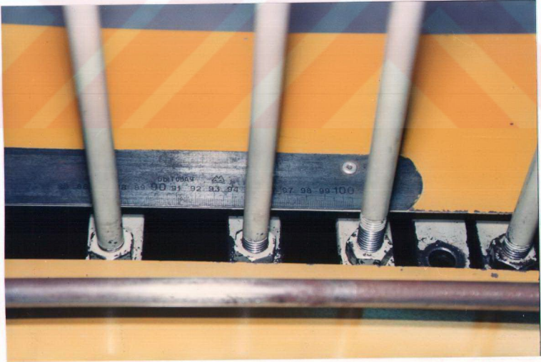
Resim 4. Çemberlerin yüzey merkezinden uzaklıklarının verilmesinde kullanılan milimetrik ölçü düzeni
