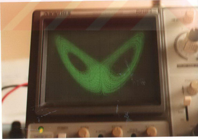
Şekil 45. Kaotik verici sistemin osiloskoptan alınan u_V - w_V faz resmi.
