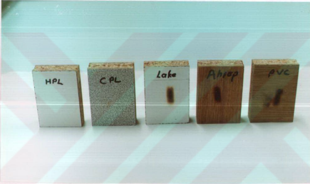
Şekil 19. Sigara Ateşine Karşı Dayanıklılık Deneyine Tabi Tutulan Örnekler
