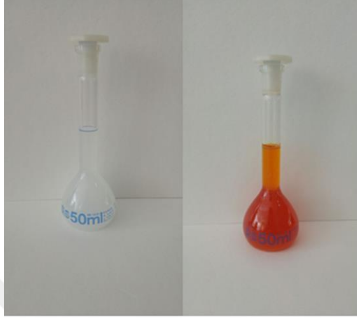
Şekil 4.3. \text{TiOSO}_4 çözeltisinde meydana gelen renk değişimi
