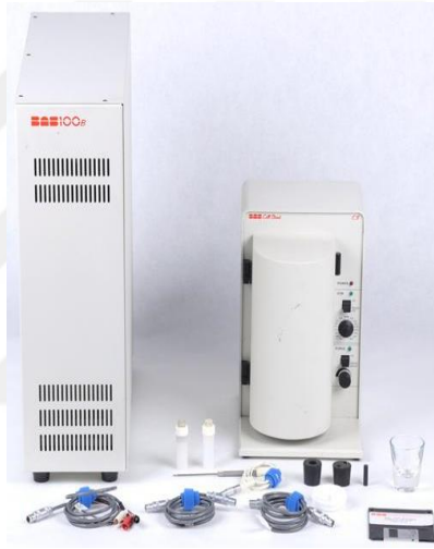
Şekil 3.10. Bir potansiyostat düzeneği ve BAS100W elektrokimyasal analizörü
