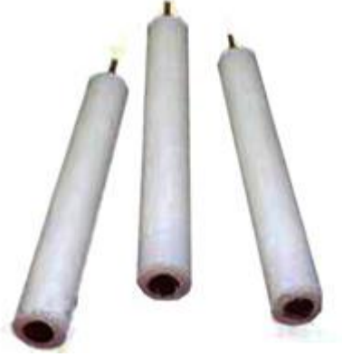
Şekil 3.7. Camsı karbon çalışma elektrodu
