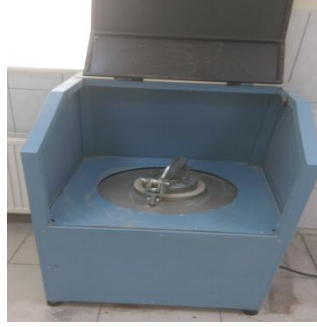
Şekil 3.1. Öğütme işleminde kullanılan değirmen cihazı
