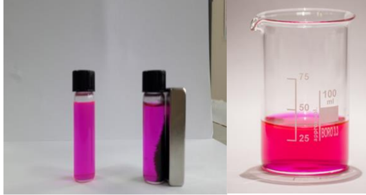
Şekil 3.4. Deney sonrasında manyetit katalizörünün mıknatısla toplanması
