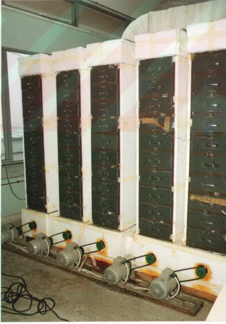
Şekil 9. Deneş düzeneğinde kanalların klima odasına bağlanması.
