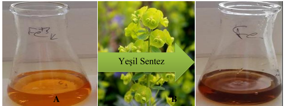
Şekil 4.3. Fe 3 O 4 nanopartikülünün yeşil sentezinin şematik gösterimi A: FeCl 2 -Fe 2 Cl 3 çözeltisi B: Fe 3 O 4 nanopartikülü
