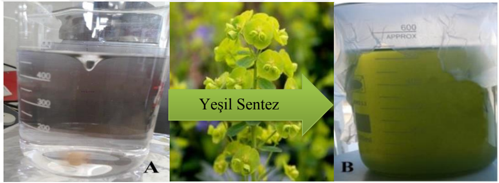
Şekil 4.2. ZnO nanopartikülünün yeşil sentezinin şematik gösterimi A: ZnCl 2 çözeltisi, B: ZnO nanopartikülü
