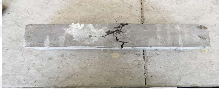
Şekil 4.5. Ezilmiş küp ve prizma numuneler
