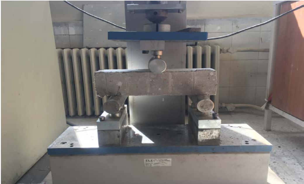
Şekil 3.7. Eğilme cihazı ve yükleme durumu
