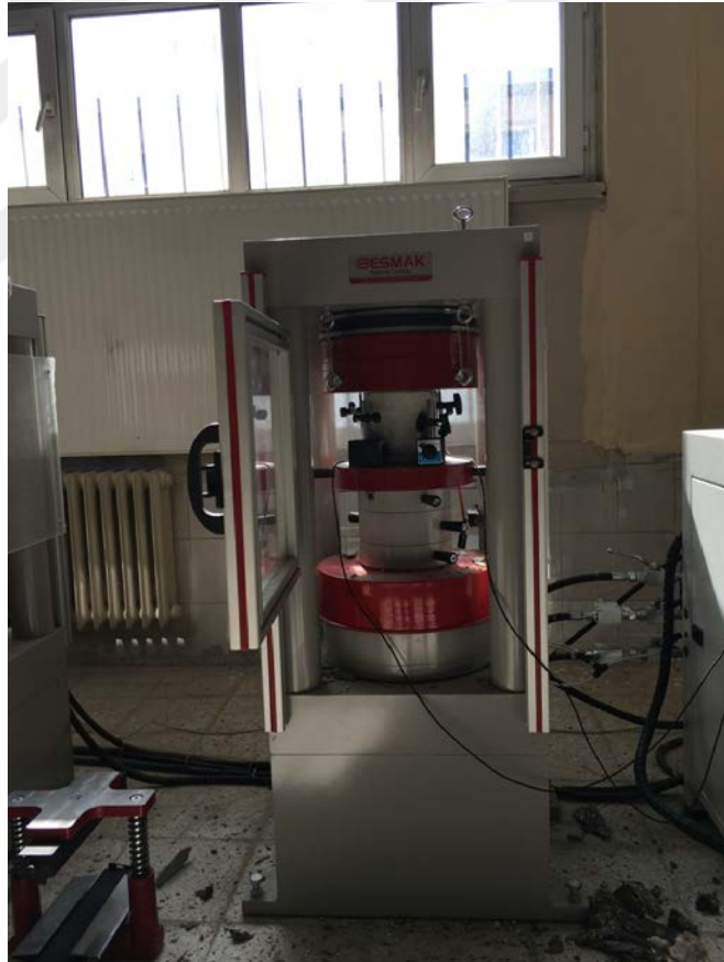
Şekil 3.8. Basınç cihazı yükleme durumu
