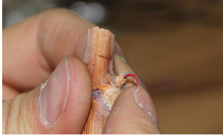
Şekil 3.2. Kış gözlerinin primer tomurcuklarına termokapıl yerleştirilmesi (Orjinal)
