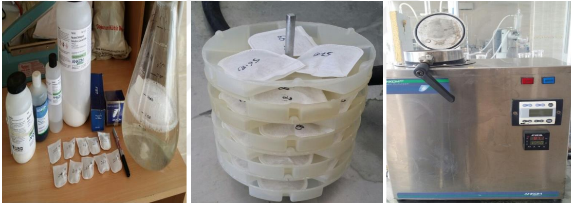
Şekil 3.4. ADF-NDF analizleri için torbaların hazırlanması ve analizde kullanılan ANKOM cihazı
