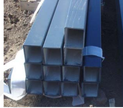
Şekil 2.3. Dairesel ve kare kesitli içi boş kazık (Guades 2013)
