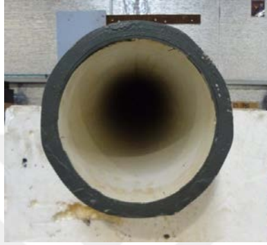
Şekil 2.3. Dairesel ve kare kesitli içi boş kazık (Guades 2013)
