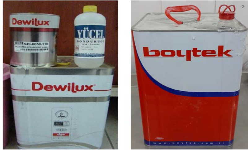
Şekil 3.1. Doymamış polyester, polyester hızlandırıcısı ve sertleştiricisi
