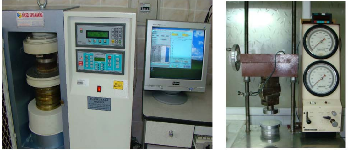
Şekil 3.10. Serbest basınç mukavemeti deneylerinde kullanılan cihazlar
