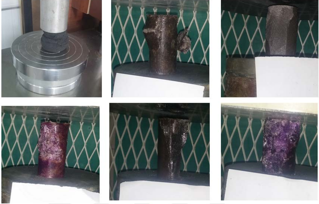
Şekil 4.1. Belirli oranlarda atık malzeme kullanılan polyester kompozit kazıkların serbest basınç mukavemetlerinin belirlenmesi
