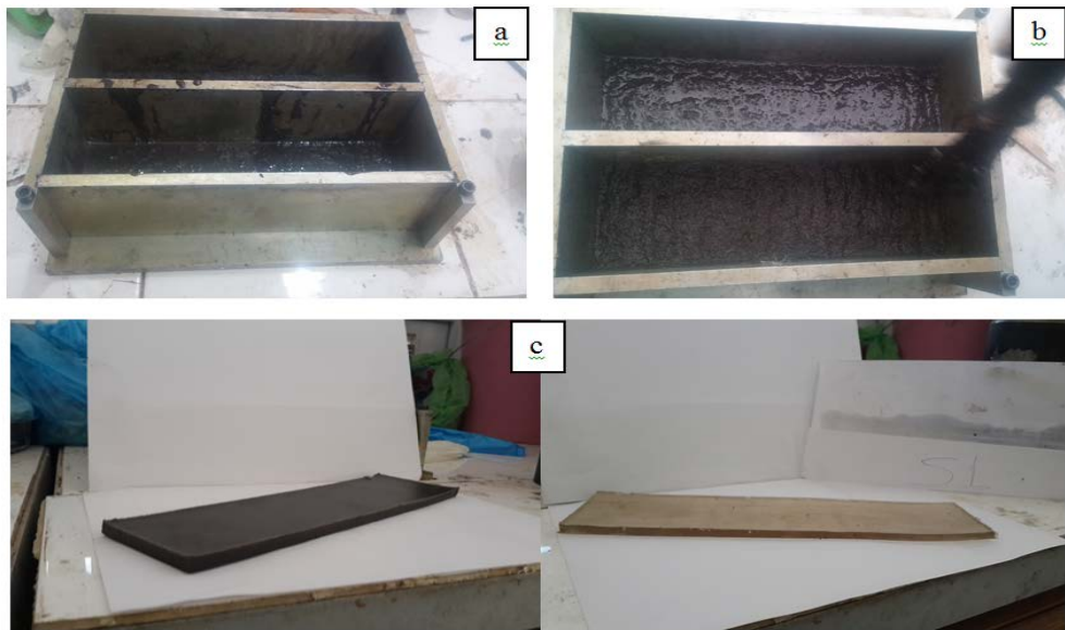
Şekil 3.11. Sönüm oranını belirlemek için kullanılan kalıp ve numuneler
