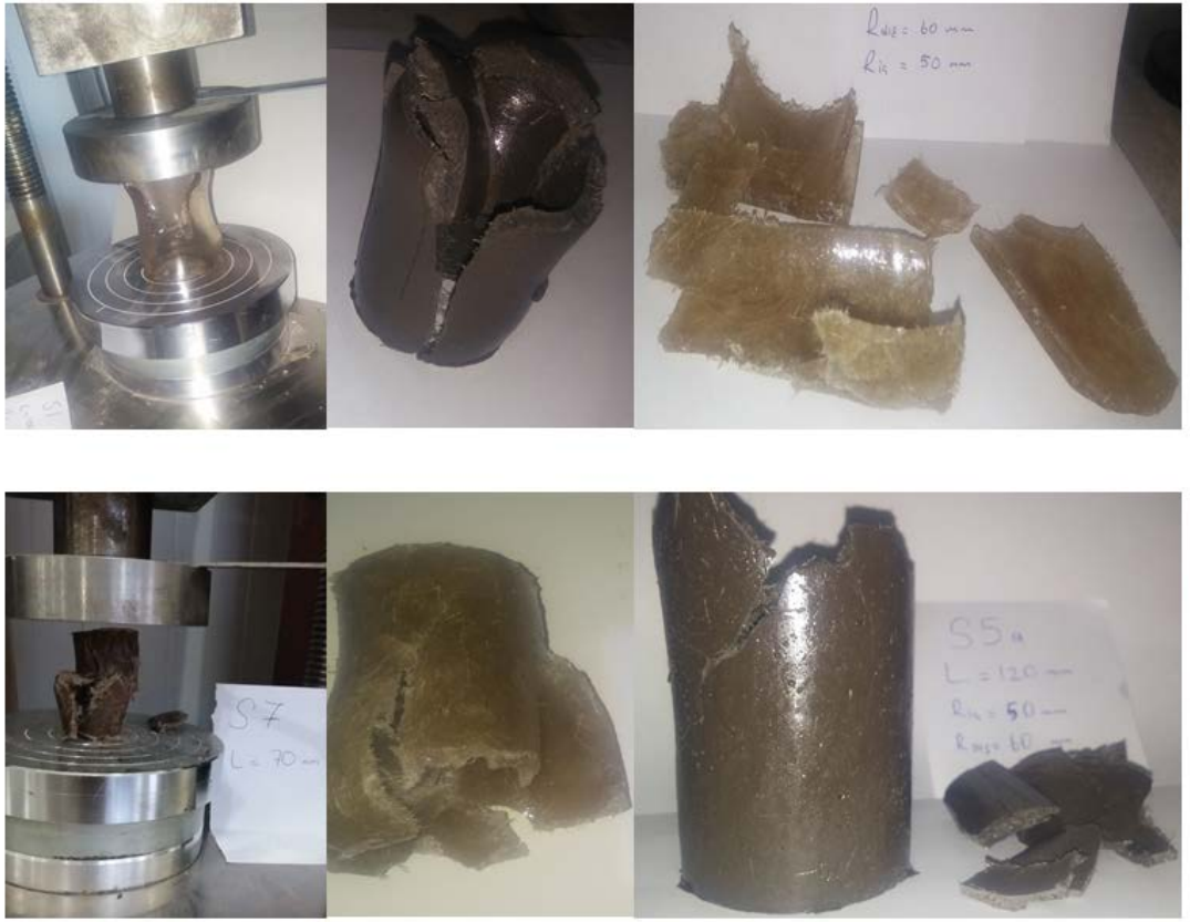
Şekil 4.8. İçi boş kazık numunelerin kazık kapasitelerinin belirlenmesi
