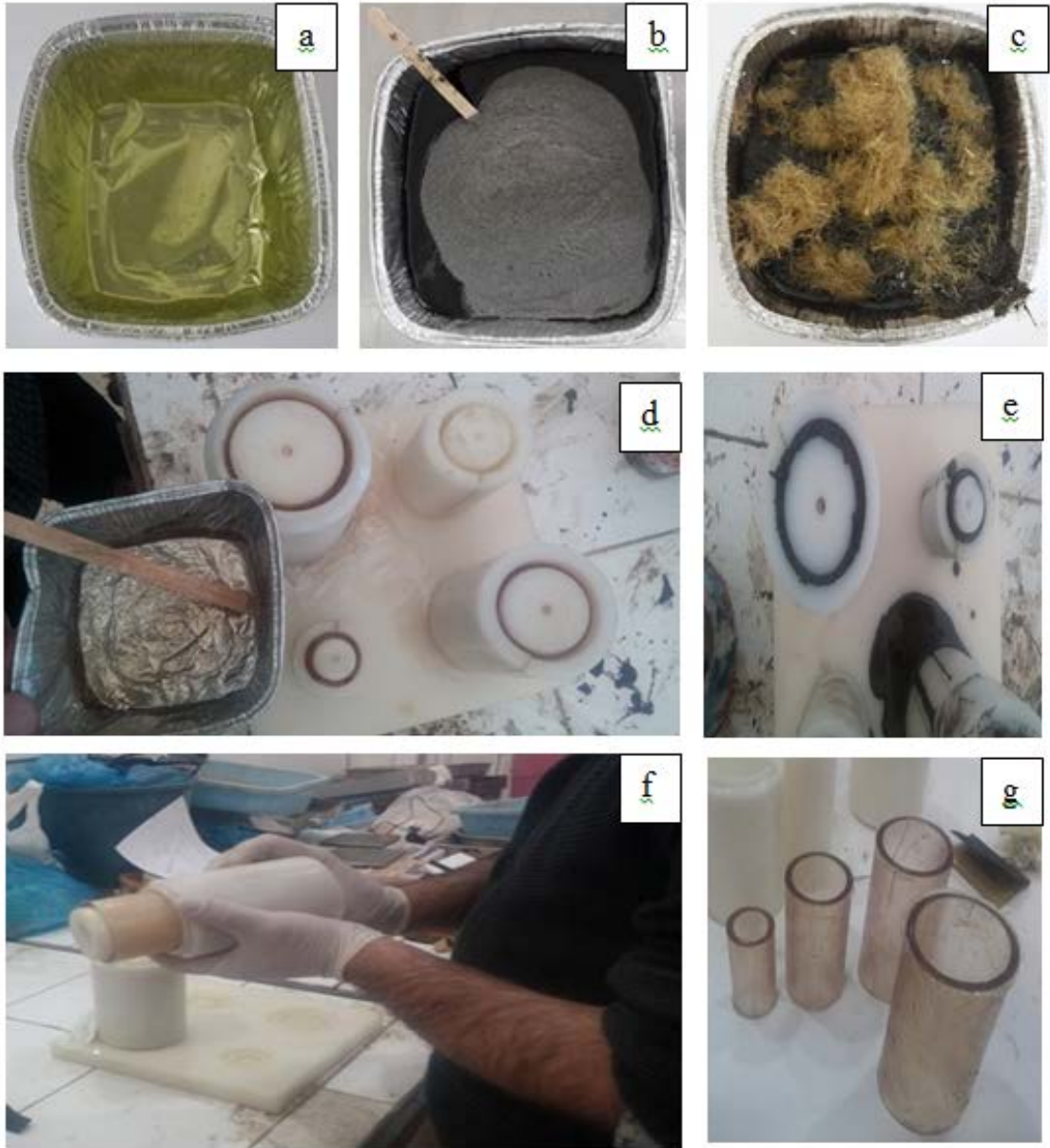
Şekil 3.9. Lif ve uçucu kül katkılı polyester esaslı içi boş kazık numunelerin hazırlanması
