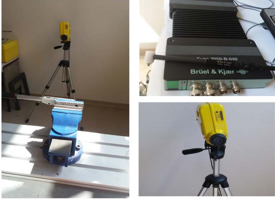
Şekil 3.12. Pulse titreşim ölçüm sistemi deney düzeneği
