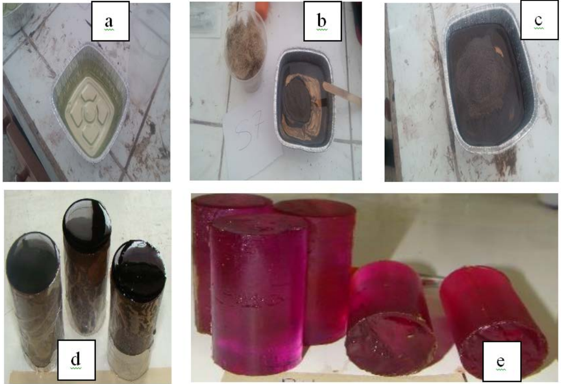
Şekil 3.8. Lif ve uçucu kül katkı polimer esaslı kompozit numunelerinin hazırlanması
