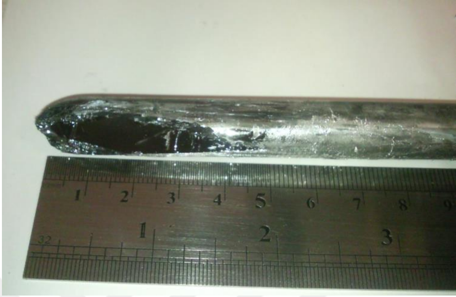
Şekil 3.8. Büyütülen GaTe yarıiletkeni
