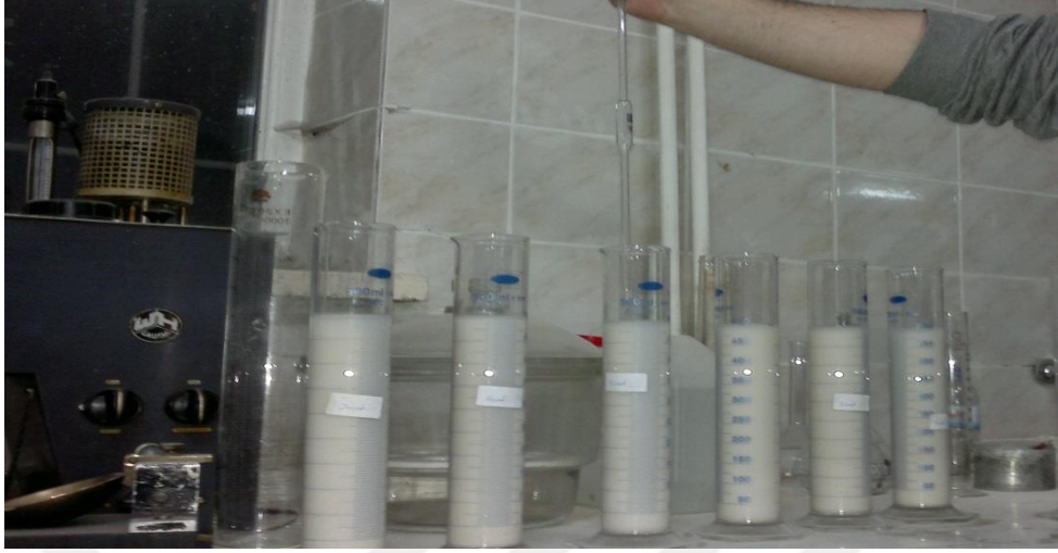
Şekil 3.2. Deneyde kullanılan CH Kil zemine ait pipet yöntemi
