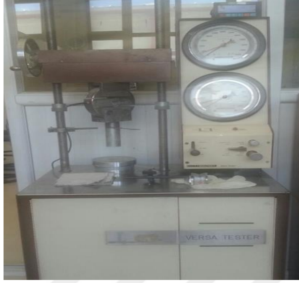
Şekil 3.3. Serbest basınç mukavemeti deneylerinde kullanılan SoilTest cihazı
