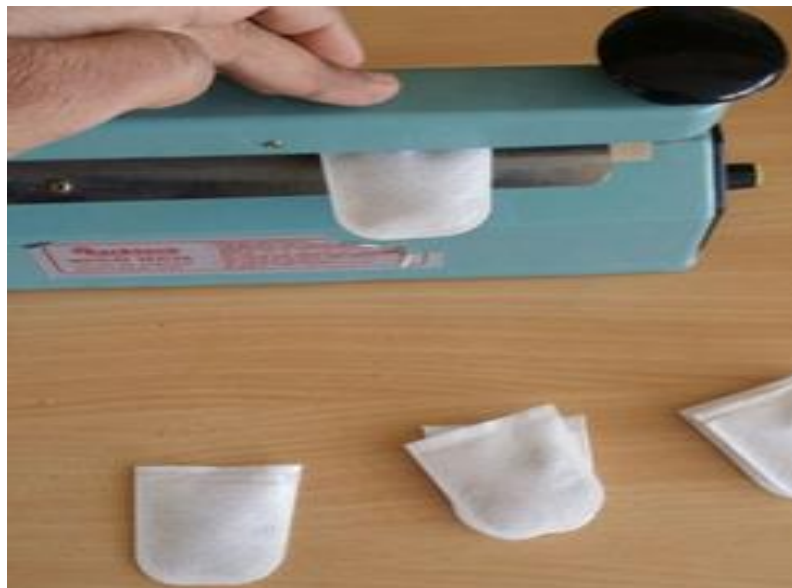
Şekil 3.8. Torbaların ağızlarının sıcak presle yapıştırılması
