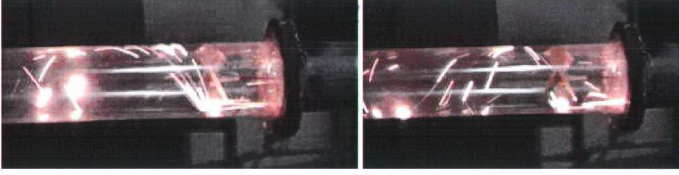
Şekil 20. Eksenel dönme üretici ve dönmeli akış oluşumu
