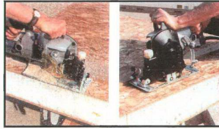
Şekil 21. OSB'nin işlenebilme özelliği [16].
