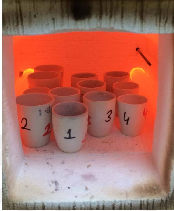
Şekil 3.14. K\u00fcl fırınında yakma iřlemi
