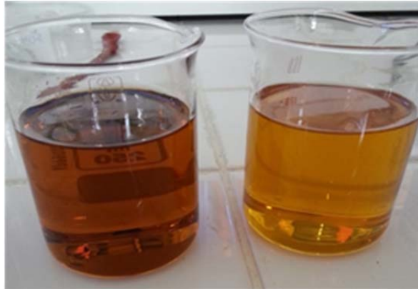
Şekil 3.7. Okside edilmemiş taze balık yağı (BY 5,5 meq/kg) ve okside edilmiş balık yağı (OBY 135,5 meq/kg)
