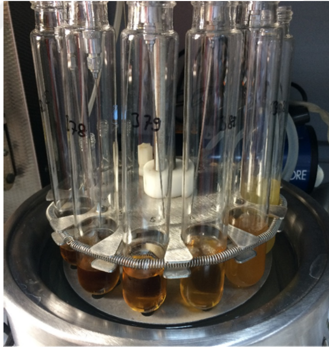
Şekil 3.12. Numunelerin evaporatörde azot gazı ve ısı ile toplam yağının elde edilmesi
