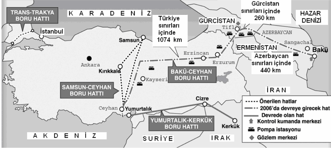
Şekil 2. BTC boru hattı pompa istasyonları güzergâhı [20].
