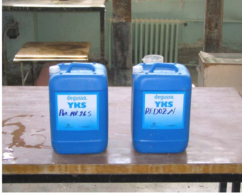
Şekil 14. POZZOLITH® MR 26 S orta düzey akışkanlaştırıcı ve RHEOBUILD® REDOZ N süper akışkanlaştırıcı.
