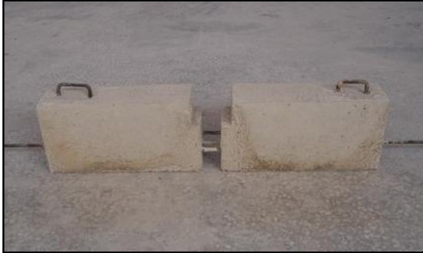
Şekil 2.14. Standart Belçika Mafsallı Kiriş Deney numunesinden bir görünüm
