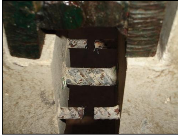
Şekil 2.15. Aderansı incelenen donatıların taşımalar sırasında zarar görmesini engellemek amacıyla konulan ve deneye başlamadan önce kesilen donatılardan bir görünümü
