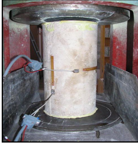
Şekil 2.4. Mekanik özelliklerin belirlenmesinde kullanılan deney numunesinden bir görünüm
