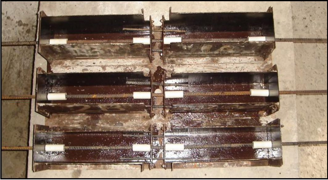
Şekil 2.13. Eğilmede aderans deneyinde kullanılan kiriş kalıpları
