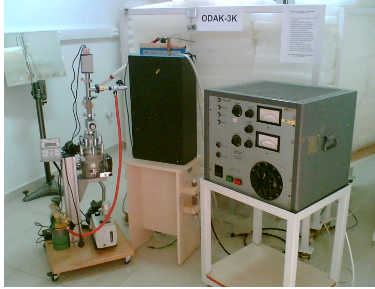
Şekil 5.10 Güç kaynağı, kapasitör, vakum sistemi
