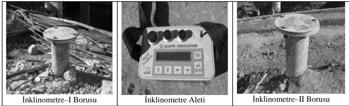
Şekil 2.7. İnklinometre-I ve II boruları ile inklinometre aleti
