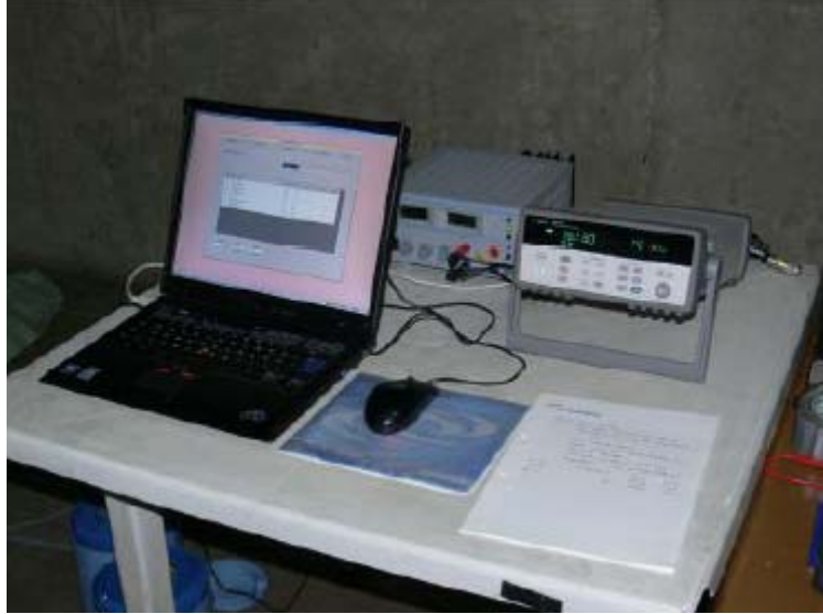
Resim 8. Keban HES Ünite 4-5 Türbin verimlilik ölçümünde kullanılan kayıt sistemi
