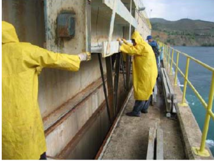
Resim 4. Altakış kısmı sıcaklık ölçüm düzeneğinin yerleştirilmesi
