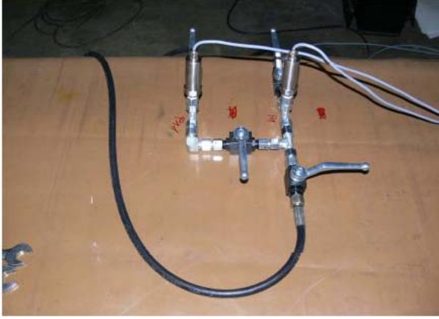
Resim 6. Basınç transdüserlerinin yerleştirilmesi
