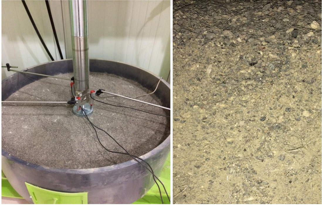
Şekil 4.2. Rastgele donatlandırılmış kum zeminin görünümü
